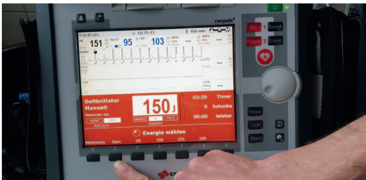
► Abb. 5 Synchronisieren Sie den Defibrillator mit dem EKG durch Drücken der „SYNC“-Taste und beachten Sie die Markierung der QRS-Komplexe.
