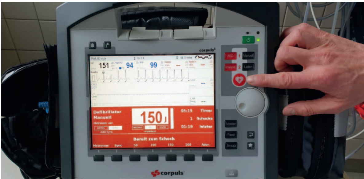
► Abb. 6 Laden Sie den Defibrillator und lösen Sie den Schock mit gedrückt gehaltener Schock-Taste aus.
